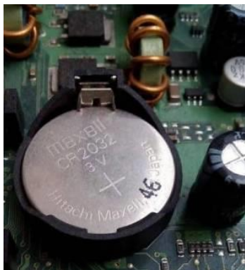
Slika 49. CR2032 baterija na matičnoj ploči
