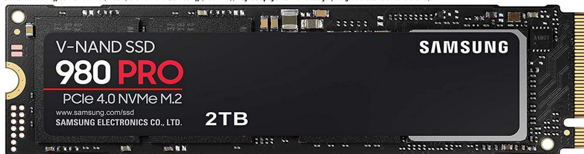
Slika 112.2. Pogled na NVMe (Flash) disk tvrtke Samsung (980 Pro), koji se spaja na M.2 sučelje (vidljivo s desne strane diska).
